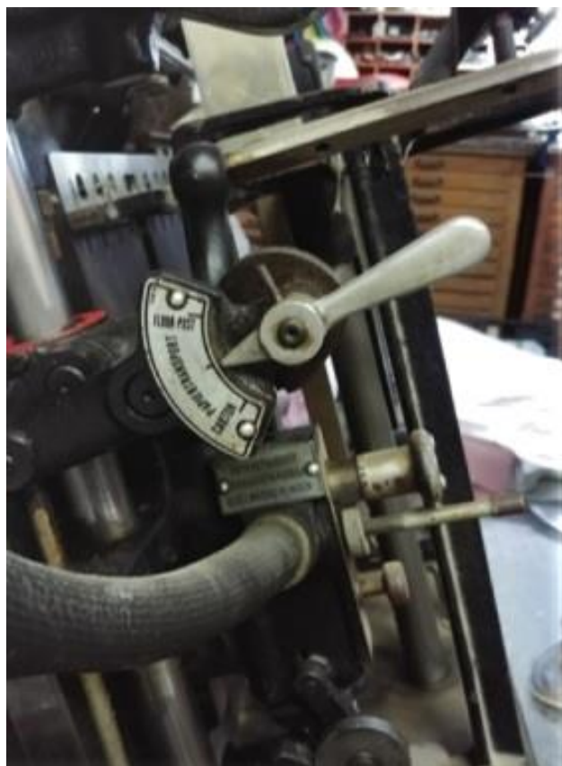
Dettaglio del sistema di aspirazione.
