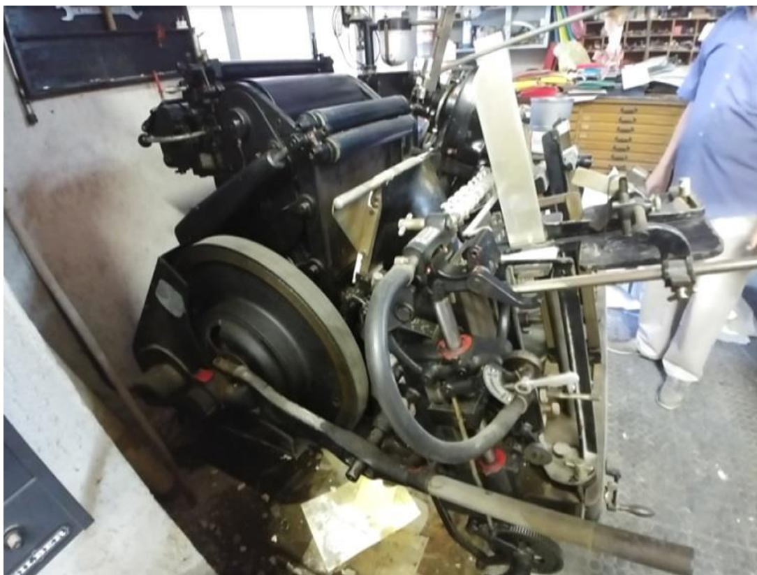
La “Original Heidelberg” serve prevalentemente per la fustellatura e per la stampa di partecipazioni con caratteri mobili (ad esempio inviti di nozze e biglietti da visita).
