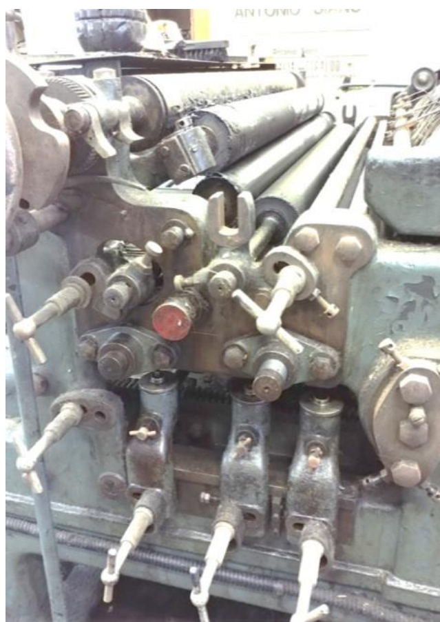
Il meccanismo dei rulli inchiostatori.
