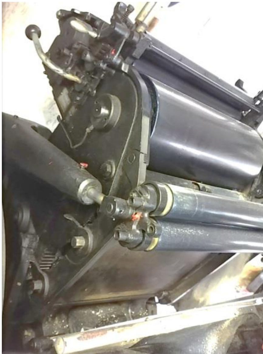
I due rulli muovendosi dall'alto verso il basso cospargono l'inchiostro sulla matrice.
