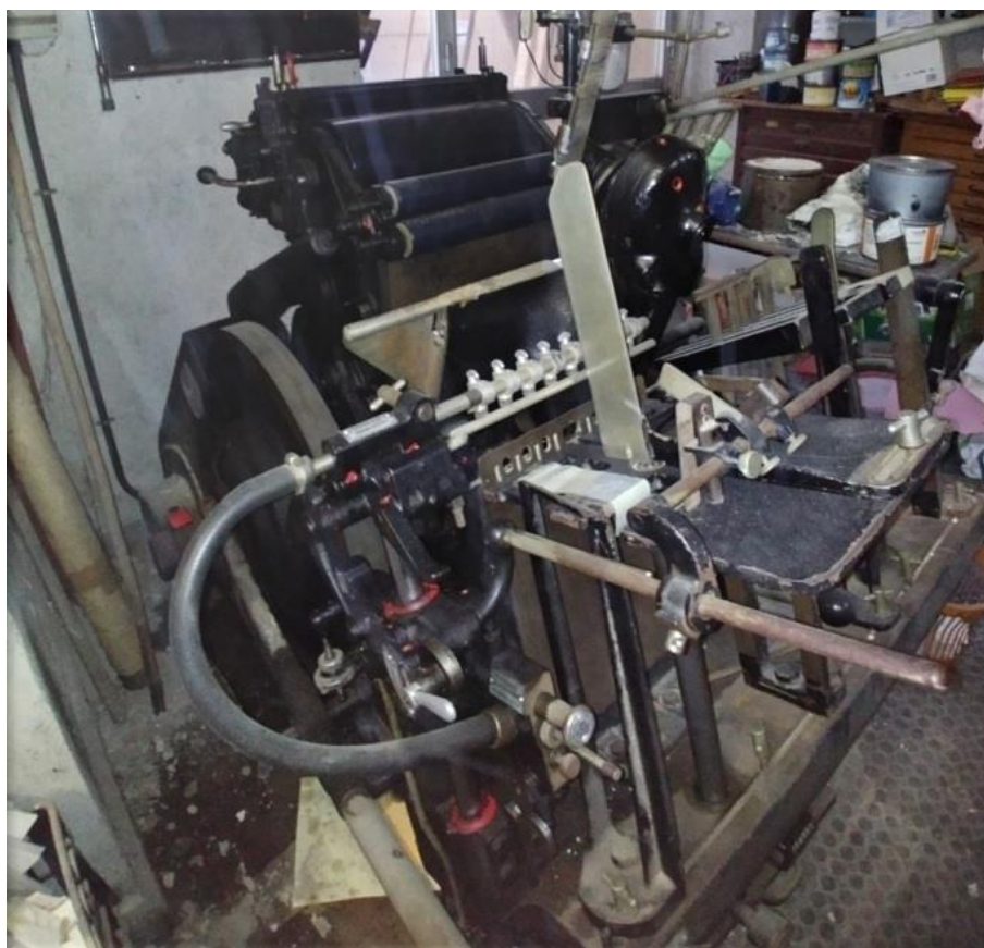
Sistema che consente l’aspirazione dell’area per sollevare il foglio da stampare.
