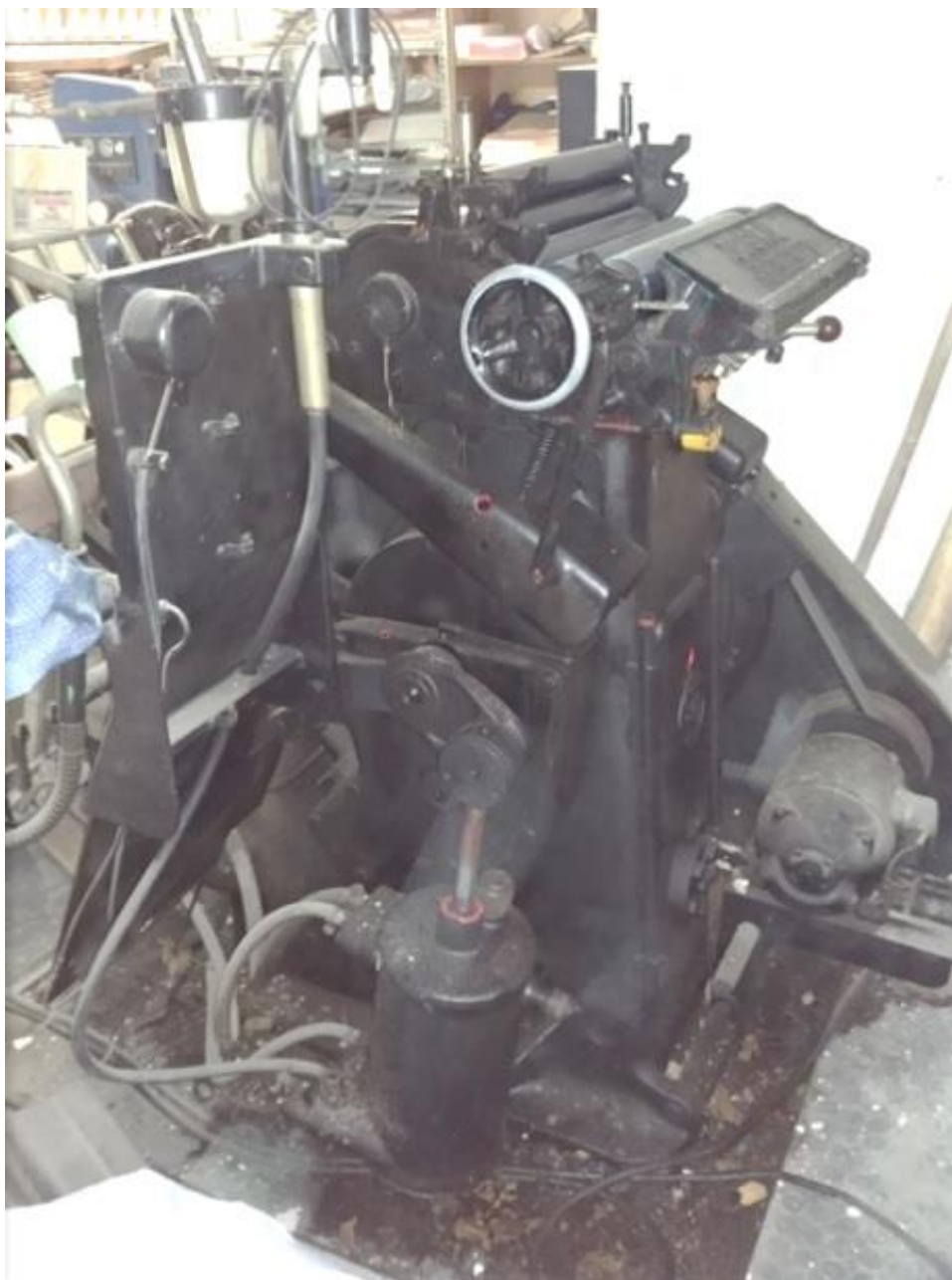
Il sistema idraulico che consente gli automatismi e la sincronizzazione del movimento dei componenti della stampa.
